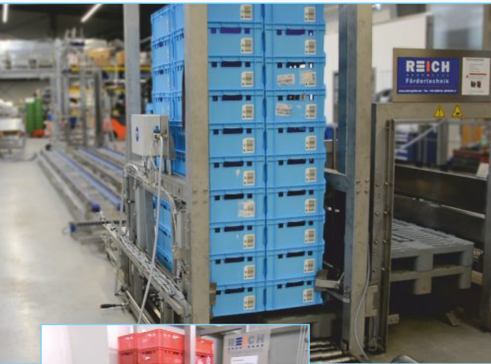
Die Vollautomatische Palettierung mit Palettenmagazin von Reich ist mit ihrem geringen Platzbedarf die ideale Ergänzung für die innerbetriebliche Palettenlogistik.
